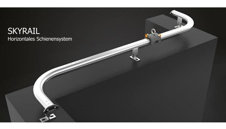
Das SKYRAIL-SYSTEM besteht aus einer salzwasserfesten Aluminiumlegierung. Das System ist als Absturzsicherung nach EN795-D zertifiziert und kann auch für seilunterstütztes Arbeiten genutzt werden.
